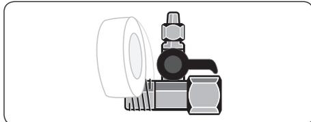
Desligue o fornecimento de água do local de instalação e rosqueie o adaptador na conexão de água da parede com uma chave de boca ou inglesa (22 mm). Utilize a tampa cega (que pode ser adquirida como acessório) para fechar o adaptador ou uma torneira com rosca  $\frac{1}{2}$ ".
