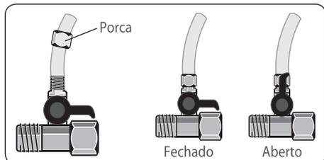
6. Conecte a mangueira na entrada do cabeçote de limpeza conectado ao filtro (IN). Abra o registro de água e deixe fluir aproximadamente 10 litros. Após, feche o registro.
