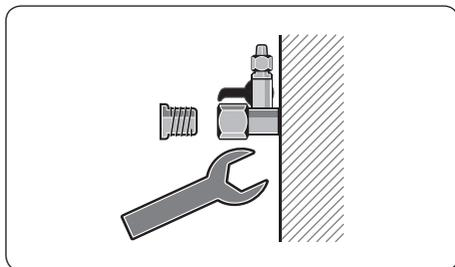
Conecte a mangueira ao conector de ¼", retirando a porca e passando-a através da mangueira.
