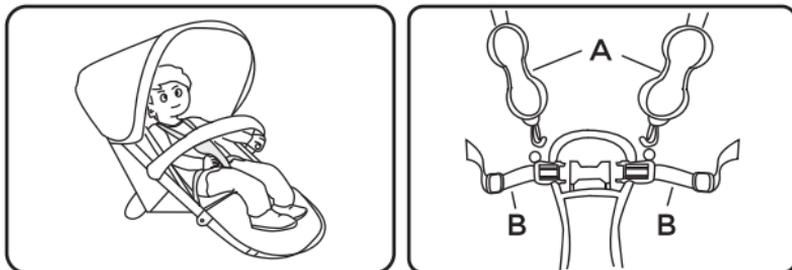
**Paso 3:** Una vez ajustados los cinturones, inserte las lengüetas de los cinturones en las hebillas hasta que se escuche un «clic». Asegúrese de que el cinturón está correctamente bloqueado, bien ajustado y sin torsión.
