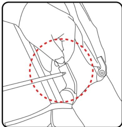
Paso 2: Cierre la capota y sujete completamente las partes elásticas. Tirando de la capota hacia adelante o hacia atrás es posible posicionarla de la manera más conveniente para su uso.
