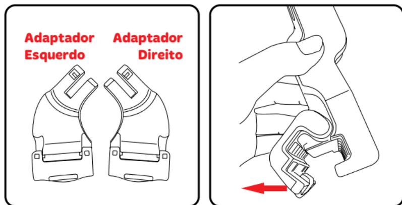
Etapa 2: Encaixe os adaptadores na estrutura do carrinho, de modo que o adaptador fique em contato com a pequena parte plástica.
