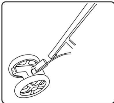
Para remover as rodas traseiras: Com uma pequena chave de fenda, pressione os parafusos para que as rodas se soltem do carrinho.
