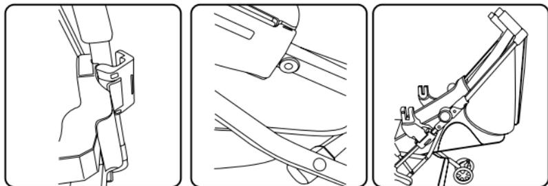
Etapa 3: Conecte o bebê conforto com a face voltada para a parte de trás de carrinho, até ouvir um “click”. O bebê conforto estará propriamente instalado.
