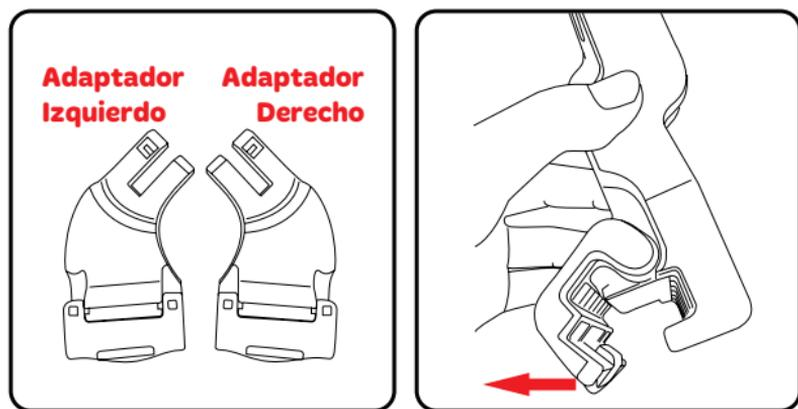
Paso 2: Enganche los adaptadores en la estructura del cochecito, de modo que el adaptador quede en contacto con la pequeña parte plástica. Presiónelos hasta oír un “clic”.
