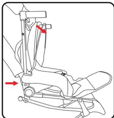
Paso 4: Cierre el cochecito completamente y coloque el seguro de cierre para evitar que el cochecito se abra de manera no deseada.
