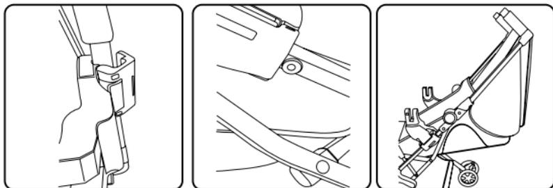
Paso 3: Coloque la butaca mirando hacia la parte posterior del cochecito hasta que oiga un “clic”. La butaca estará correctamente instalada.
