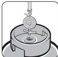
3. Conecte o regulador de gás ao botijão, apertando-o somente com as mãos. Este sistema foi desenvolvido para vedação somente com a força "manual", não necessitando ferramentas.
