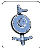
Use sempre um regulador de pressão para qualquer tipo de botijão. A ausência deste pode causar excesso de pressão e vazamento de gás. O regulador de pressão do gás deve ser de 2,75 (2,8) kPa de pressão e, no
