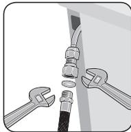
2. Encaixe o anel de vedação dentro do adaptador e fixe o tubo flexível metálico ao adaptador, usando duas chaves ajustáveis.
