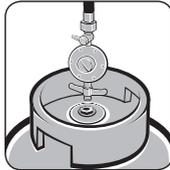
4. Conecte o regulador de gás ao botijão, apertando-o somente com as mãos. Este sistema foi desenvolvido para vedação somente com a força "manual", não necessitando ferramentas.
