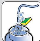
Nunca use chamas ou faíscas para localizar vazamentos de gás, pois podem provocar explosões. Utilize uma esponja com espuma de sabão ou detergente líquido.
