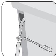
1. Coloque a abraçadeira de metal na ponta da mangueira, em seguida, encaixe a mangueira no ponto de entrada do fogão e aperte a abraçadeira com a chave de fenda.
