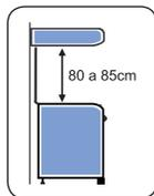
Respeite a altura de 80 a 85cm entre o fogão e um móvel, um depurador de ar ou uma coifa instalada acima do produto.
