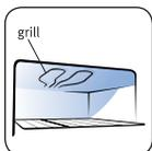
O Grill é uma resistência elétrica instalada na parte de cima do forno, que aquece e emite radiação infra-vermelha que serve para dourar, grelhar ou gratinar os alimentos.
