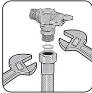
3. Encaixe o anel de vedação na outra extremidade e fixe o tubo flexível metálico no registro de parede com rosca externa 1/2", usando duas chaves ajustáveis.
