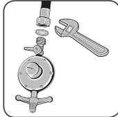
3. Encaixe o anel de vedação dentro da outra extremidade e fixe o tubo flexível metálico no regulador de pressão com registro de rosca externa 1/2", usando a chave ajustável.
