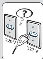
Antes de ligar o seu fogão, verifique se a tensão da tomada onde será ligado é igual à indicada na etiqueta localizada próxima ao plugue (no cabo de alimentação elétrico), ou na etiqueta de identificação do fogão.
