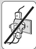
Ligue seu fogão a uma tomada exclusiva, não utilize extensões ou conectores tipo T (benjamim). Esse tipo de ligação pode provocar sobrecarga na rede elétrica, prejudicando o funcionamento do seu fogão e resultando em acidentes.
