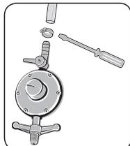
2. Coloque a outra abraçadeira na extremidade oposta da mangueira, em seguida, encaixe a mangueira no regulador de pressão e aperte a abraçadeira com a chave de fenda.
