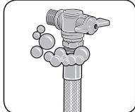
4. Ligue o gás e verifique se existem vazamentos utilizando o detergente líquido viscoso, que garante um melhor desempenho e eficácia do teste.
